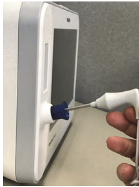
Insertion de la sonde dans le support de sonde.
