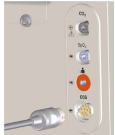
Connexion du câble ECG
