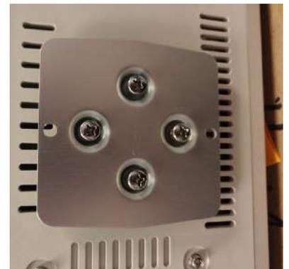
**Remarque:** Il faut que la partie bombée de la plaque métallique soit orientée vers le moniteur et les parties percées vers l'avant (écran) et l'arrière de l'appareil.
