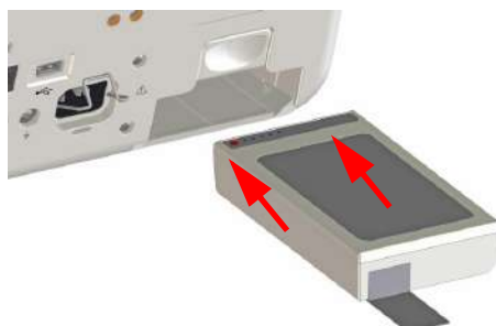
Figure 16 Installation de la batterie
