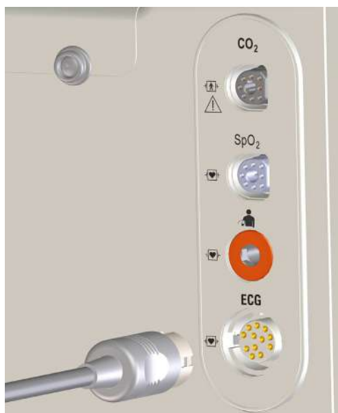
Figure 7 Connexion du câble ECG
