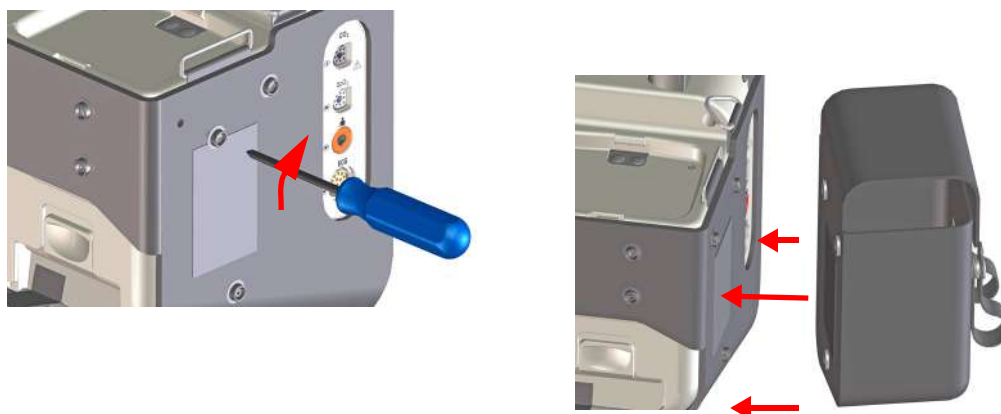
Figure 23 Fixation du socle et des rangements latéraux
