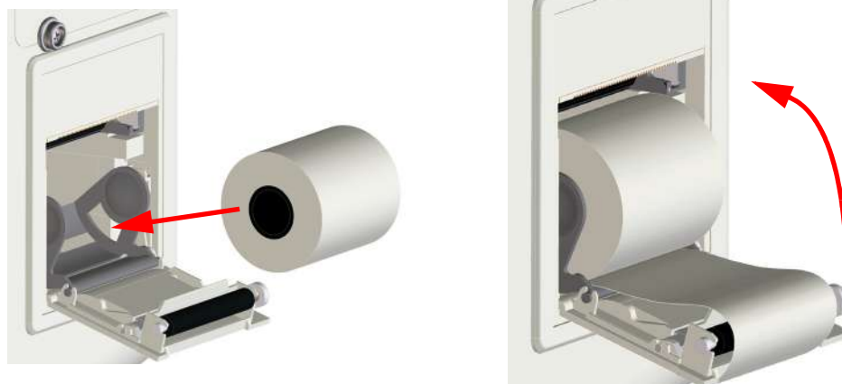
Figure 20 Installation du rouleau de papier dans l'imprimante
