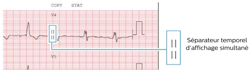
Figura 4-19 Séparateur indicatif d'un affichage simultané des dérivation sur le rapport ECG
